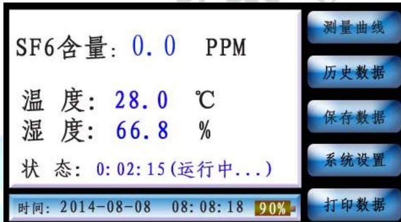
进入“测量界面”后，触摸键有：【测量曲线】、【历史数据】、【保存数据】、【系统设置】、【打印数据】。按动相应的按键可以进入“测量曲线”、“历史数据”、“保存数据”、“系统设置”、“打印数据”。
