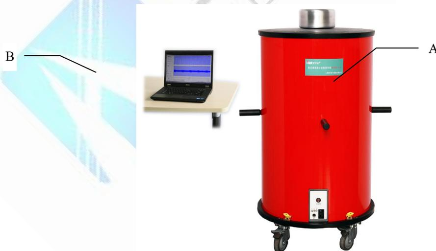
A、一体化阻尼振荡波单元， B、测控主机
