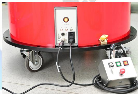
图 4-1 HZZDB-60 和外部安全控制单元连接
