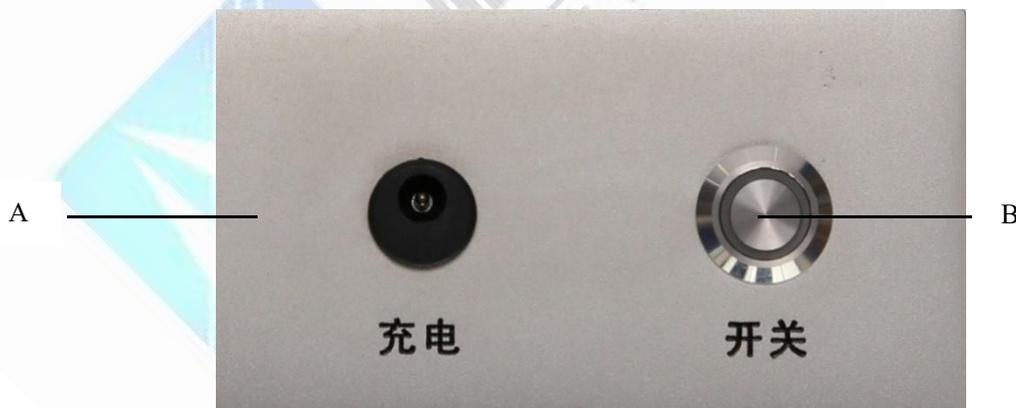
A、电池充电接口（9V 适配器） B、电源开关/指示灯
