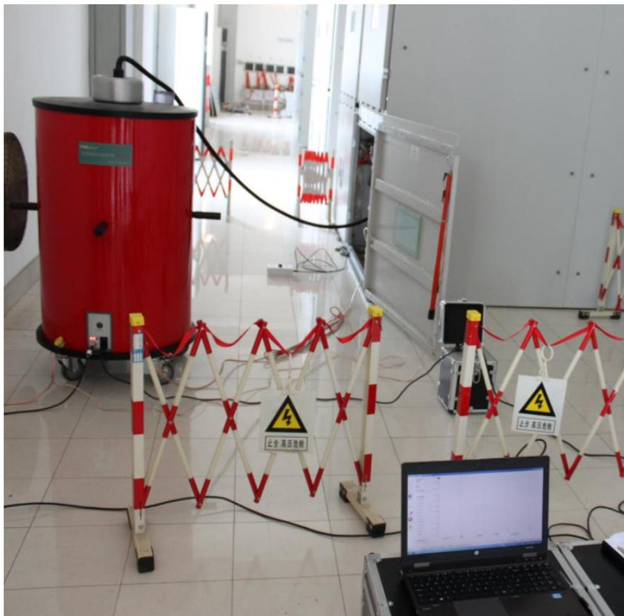
图 7-7 HZZDB-60 测试现场连接图
