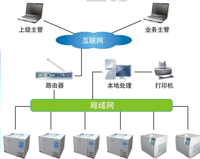
图 1.2 HZSP 气相色谱分析仪的运行简图
