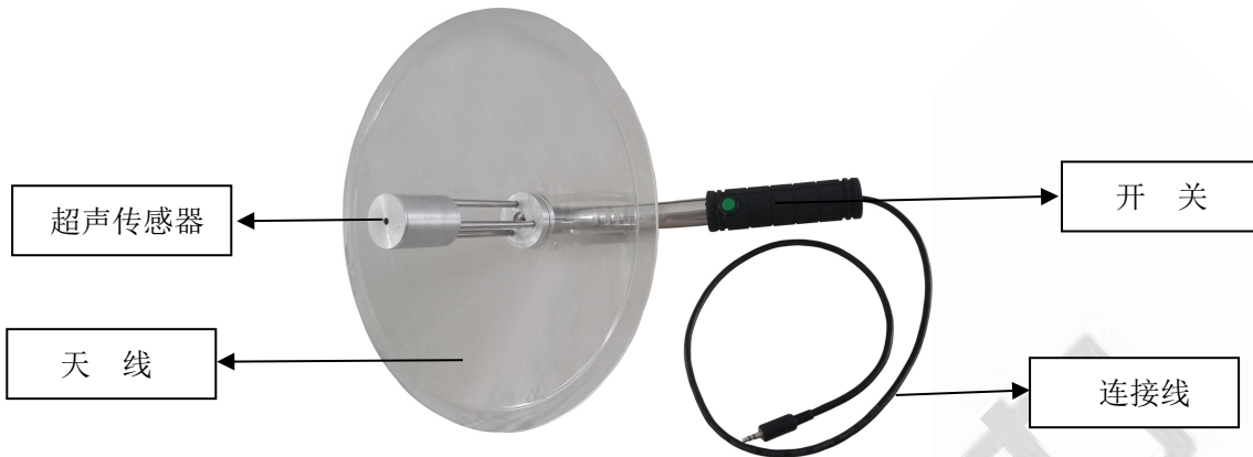
外置手持式超声波聚能器示意图
