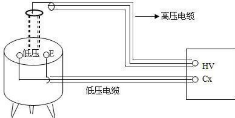
图 5 标准电容 BR16 正接线（非接地试品）接线法
